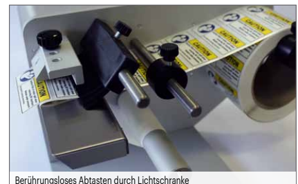
Berührungsloses Abtasten durch Lichtschanke
