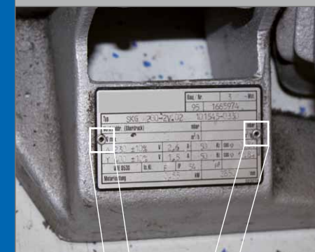
Geprägtes Aluminiumschild- genietet
