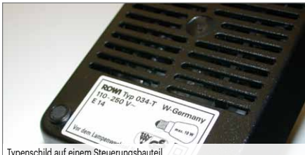
Typenschild auf einem Steuerungsbauteil
