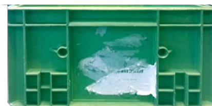
KLT verunreinigt durch Etikettenreste
